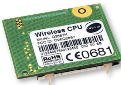
Рис. 5. Беспроводной процессор Q2687
